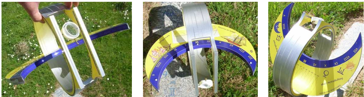
Le prototype de l'« amersphère » en plein soleil. La précision atteint les 30 s dans la lecture du TVL.
