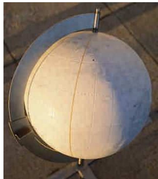
Cadran à méridien mobile en marbre au Deutsches Museum à Munich. La partie mobile sur le méridien permet de déterminer la déclinaison.
