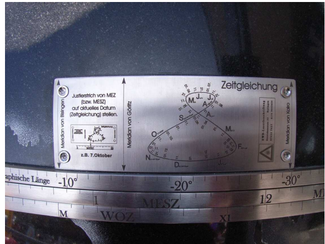
A droite : la plaque de l'équation du temps permet le réglage de la date.
