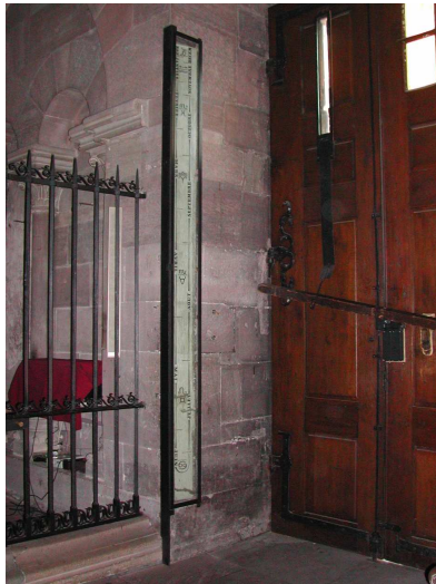
En haut, la tôle galbée qui sert de style. A la verticale, la fente par où pénètre l'ombre. La méridienne est située derrière la porte (photo au centre). On peut remarquer la fente verticale vue de l'intérieure de la cathédrale.
