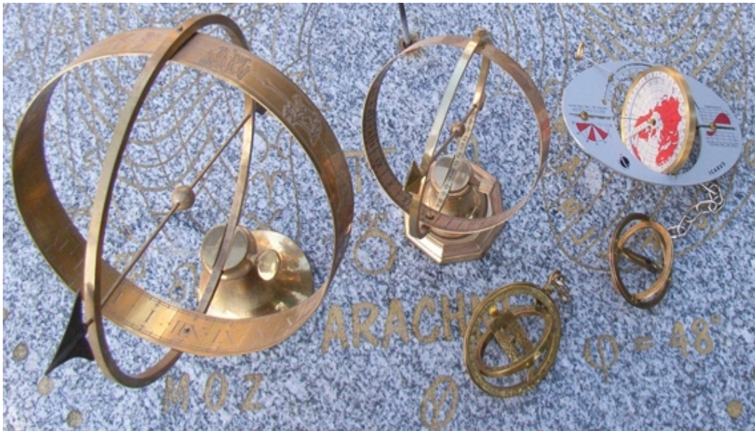
A gauche : deux cadrans équatoriaux. Ils représentent une simplification extrême de la sphère armillaire.
